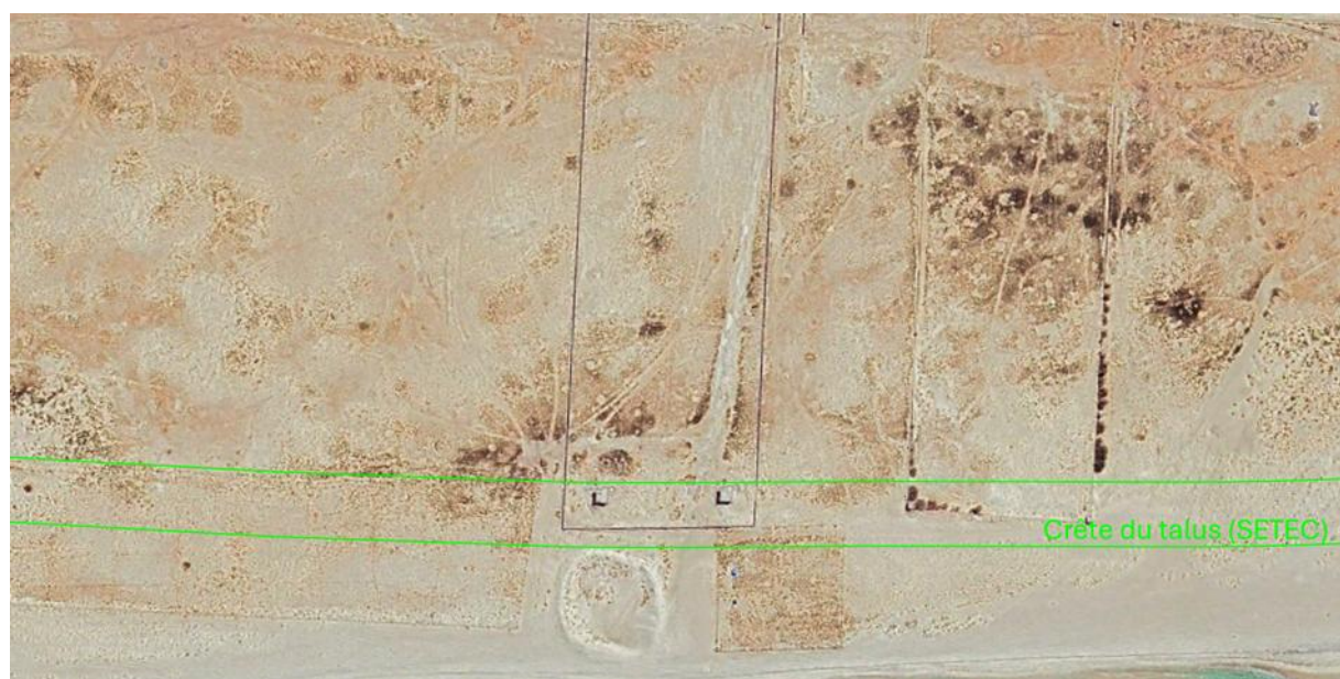
Figure 65 : Construction en cours avec clôture et bâtiments directement sur la crête du talus (zone A)
